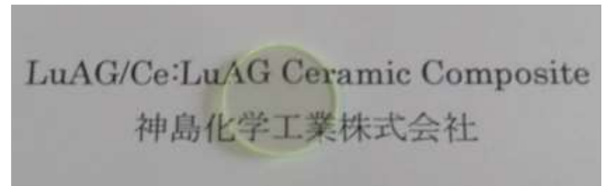
接合LuAGセラミックスシンチレーター
