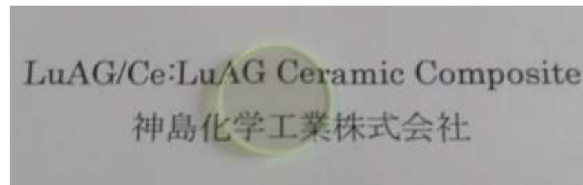
接合LuAGセラミックスシンチレーター
